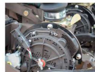
Dosificación Neumática con dosificadores vSet Classic Precision Planting con motores eléctricos.
