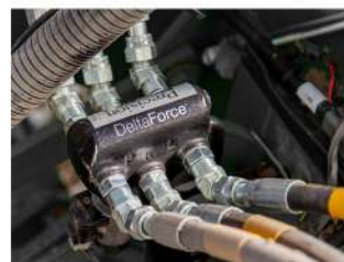
Sistema DeltaForce para máxima estabilidad de los cuerpos de siembra.
